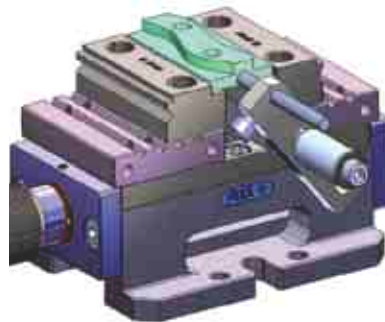
Pièce à usiner 40 x 80 x 12 mm
