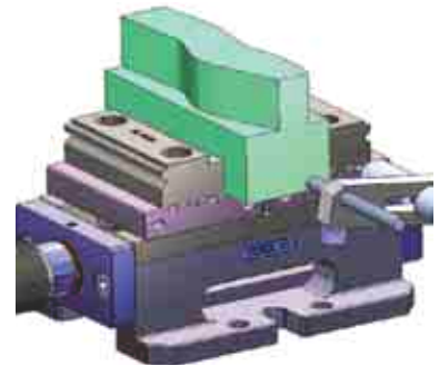
Pièce à usiner 50 x 128 x 70 mm
